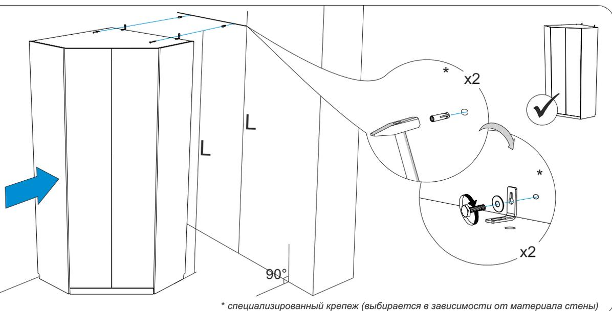
\* специализированный крепеж (выбирается в зависимости от материала стены)
